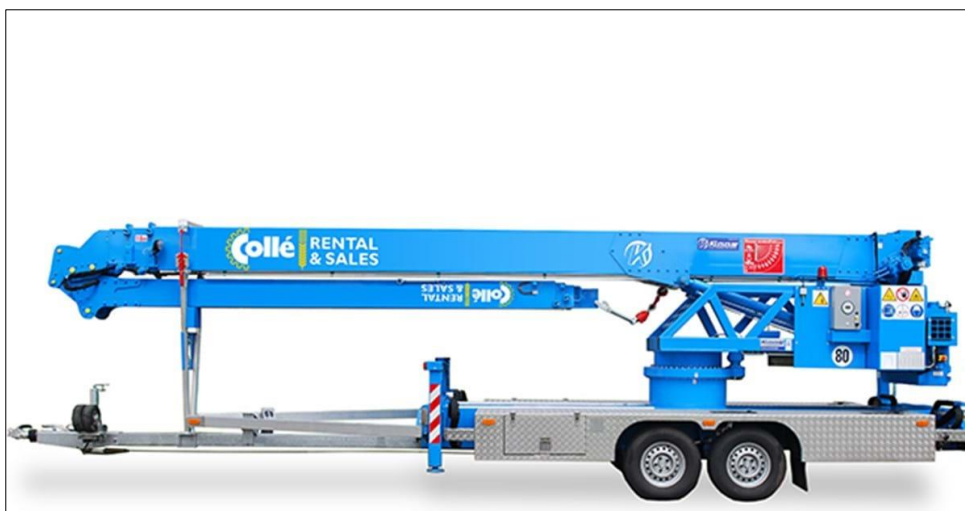
Voorbeeld van een lichte, mobiele kraan. Geschikt voor plaatsen gevelbekleding en aanreiken dakleer.
